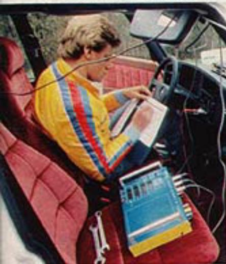
● **Teknikens världs exakta mätningar av acceleration, bränsleförbrukning etc görs med hjälp av en för tidningen specialkonstruerad kördator. Hastomet. Testförfarna får via den direkta besked om bilens prestanda. En givare kopplad till ett av de icke drivande hjulen ger exakt körsträcka (på centimetern) och hjälper oss att undvika de felmätningars risker som ett s k femte hjul tyvärr alltid innebär.**
