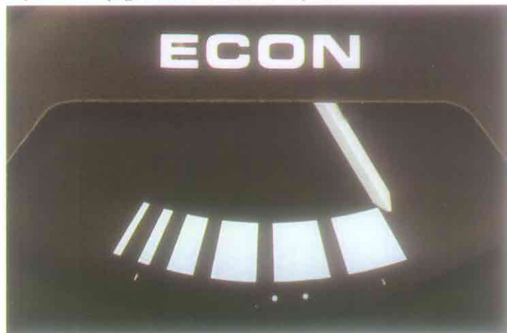
Ekonometeren i bilarna med bensinmotor hjälper dig köra ekonomiskt.
