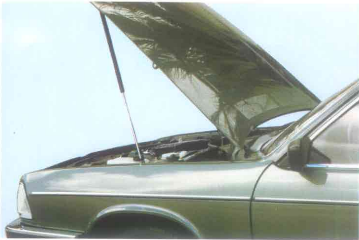
Motorhuven hålls uppe av en kraftig gasfjäder.
