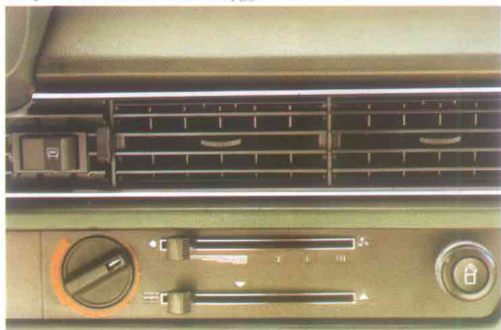
Ventilationsmunstycket längs hela panelen leder luftströmmen genom kupén på ett behagligt sätt.
