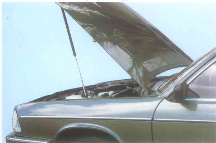
Motorhuven hålls uppe av en kraftig gasfjäder.
