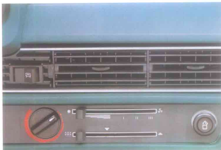
Ventilationsmunstyckena längs hela panelen leder luftströmmarna genom kupén.
