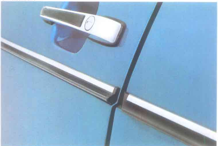
En gummilist längs längsidan har dels uppgiften att skydda mot parkeringsskador, dels att hindra nedsmutsning av sidorutorna.
