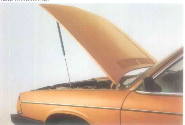
Motorhuvn hålls uppe av en kraftig gasfjäder.
