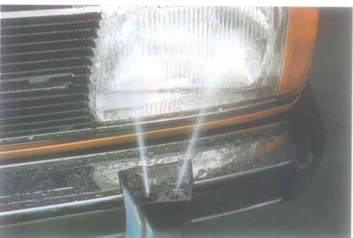
Strålkastarrensöringen med dubbla högtrycksmunstycken på båda modellerna.
