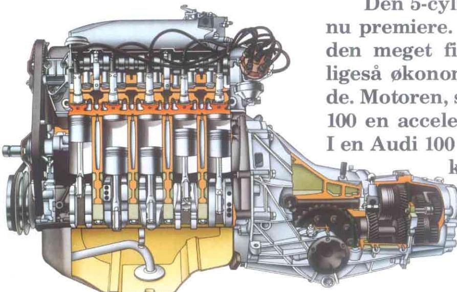
Den 5-cylindrede Audi 100 motor har nu premiere. En af de særlige fordele er den meget fine motorgang. Motoren er ligeså økonomisk som mange 4-cylindrede. Motoren, som yder 136 HK, giver Audi 100 en acceleration fra 0 - 100 på 9,5 sek. I en Audi 100 5E går alle glæderne ved at køre bil op i en højere enhed: Den kraftfyldte acceleration. Den afslappede kørsel. Den betryggende sikkerhed, takket være en fremragende teknik.
