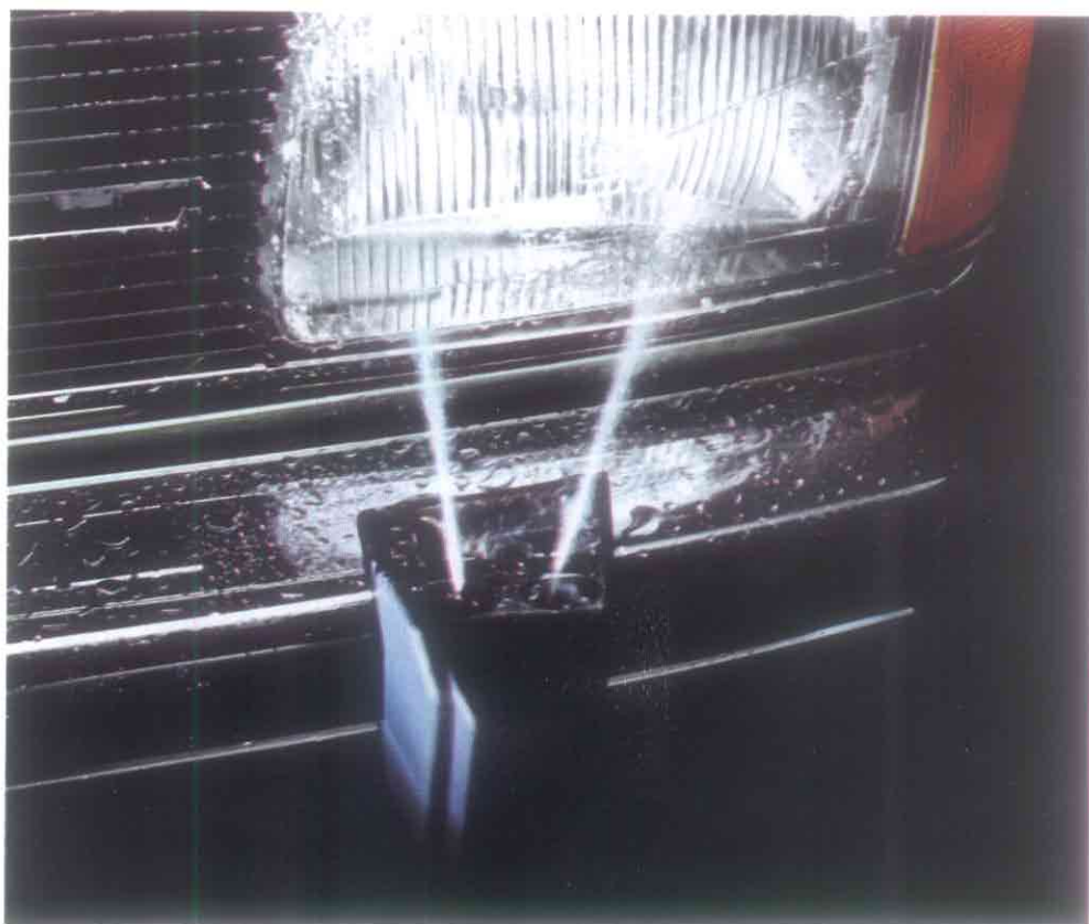
Forlygtevasker anlægget sørger for at lygteglassene er rene hele tiden, så lyset på bilen er optimalt. Blot en ringe tilsnavsning af lygterne kan nedsætte lysvirkningen stærkt.
