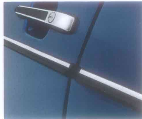
Pyntelisten på siden er forsynet med en elastisk profil, som beskytter lakken ved mindre parkeringsuheld.
