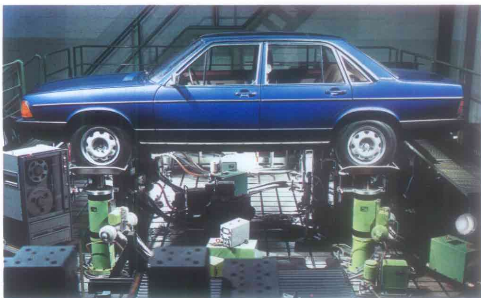
Testen på vibrationsprøvestanden svarer til 850.000 km's kørsel.
