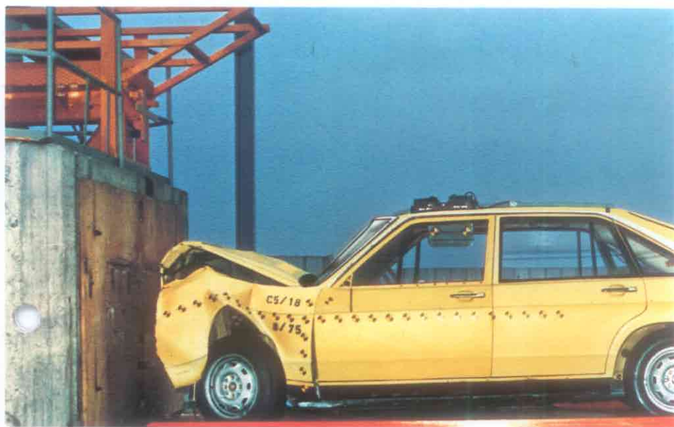
Ved frontale kollisionersforsøg har det vist sig, at sikkerhedskarrosseriet giver virkelig god beskyttelse.
