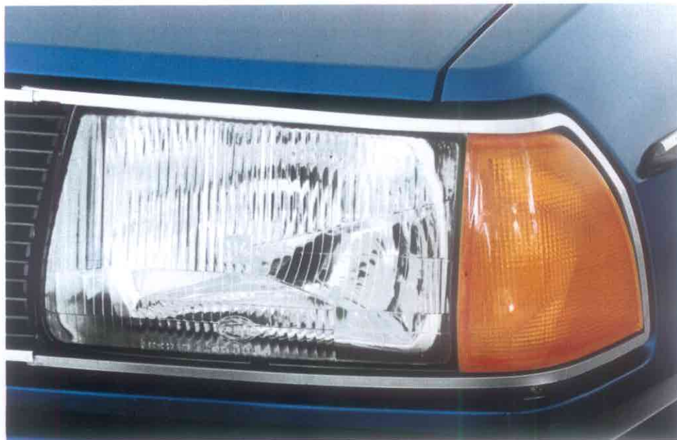
Uden at skulle bruge værktøj, kan Halogen-lygterne indstilles i højden. Det er vigtigt hvis vognen er tungt lastet bagtil.
