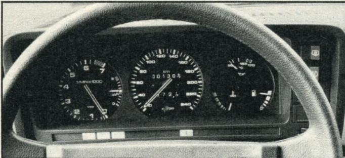
Der Ladedruckanzeiger ist im Drehzahlmesser integriert
