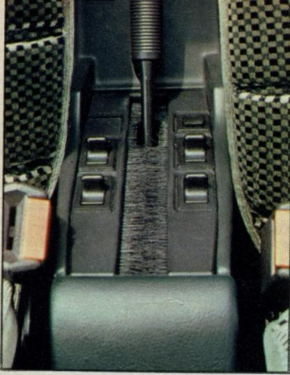
**Tasten für elektrische Fensterheber beiderseits der Handbremse**
