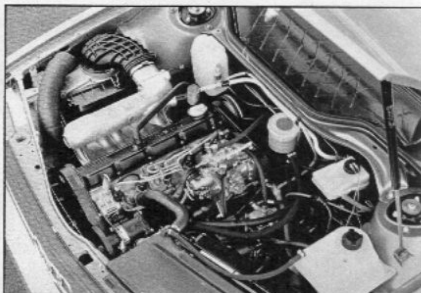
Der Zweiliter-Diesel hat das gleiche Ansaugrohr (im Foto oben) wie der 2,2 Liter-Fünfzylinder als Einspritzer.
