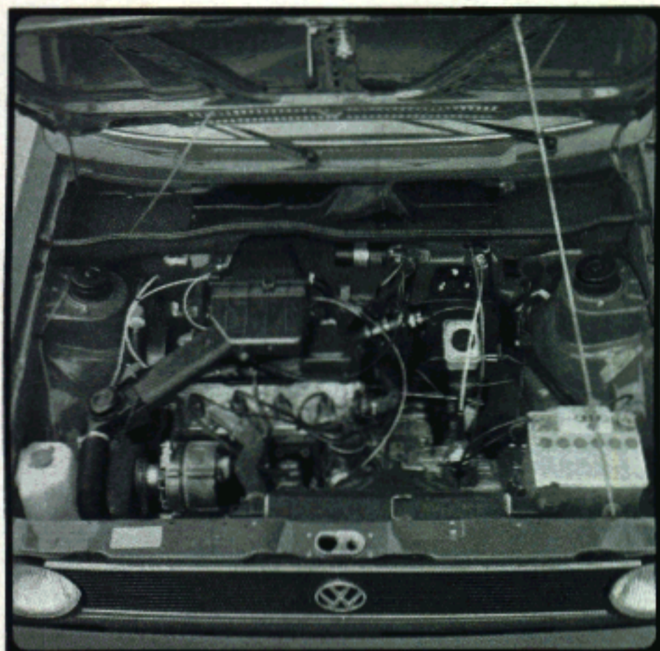
Bewährt: Das 1,5 Liter-Triebwerk des Golf
