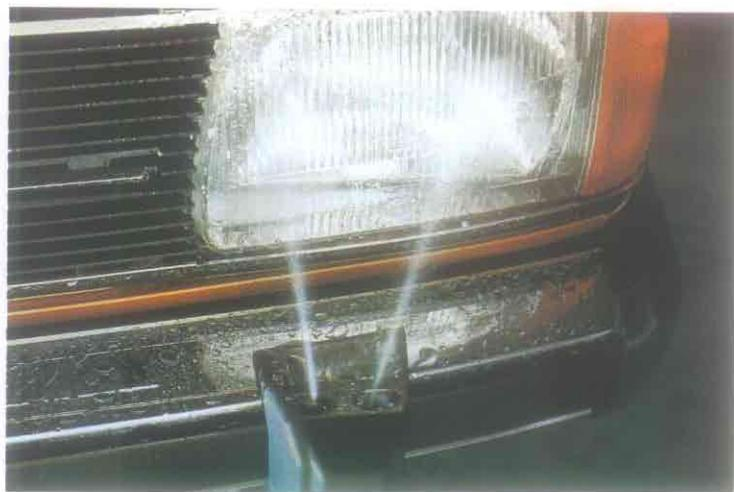
GLモデルのヘッドライトウォッシングシステム
