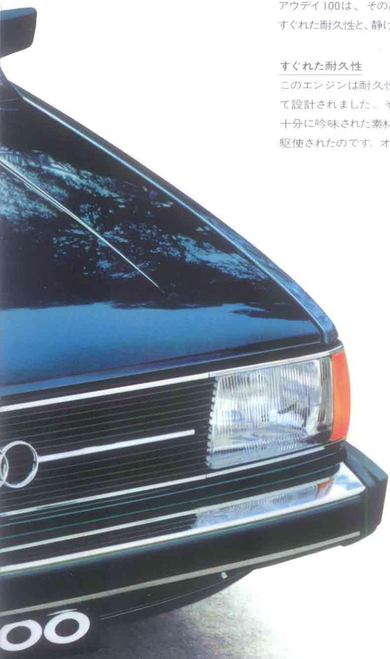
すぐれたロード ホールディングを発揮するフロント ホイール ドライブ。豪快な加速性能を誇る強力エンジン。悪路にもすぐれた乗心地を生むシャーシ。さらに、パンクやスリップ時にも、直進性が確保されるセルフ スタビライジング ステアリング システム。
