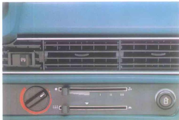
3スピード ブロワーによる効果的なベンチレーション・ヒーティング システム
