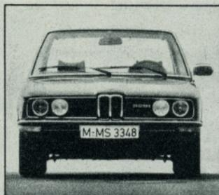
**BMW** Der schnellste Konkurrent des Audi 200 5T heißt BMW 528i – gutgehende Exemplare bringen es auf eine Höchstgeschwindigkeit von 213 km/h. In den mittleren Drehzahlbereichen jedoch, wo der 5T vom Dampf des Turboladers profitiert, muß sich der 528i geschlagen geben. Das maximale Drehmoment des BMW-Einspritzmotors liegt relativ hoch und will dementsprechend über die Drehzahl gefordert werden.
