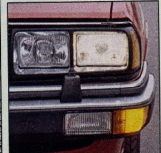
Tief zerklüftete Doppelscheinwerfer mit serienmäßiger Reinigungsanlage
