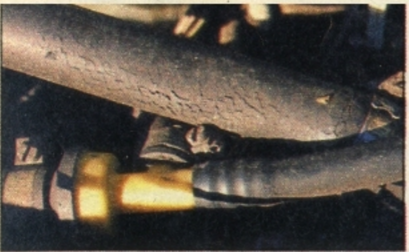
Kurbelgehäuse-Entlüftung: Dieser Schlauch ist schon arg porös
