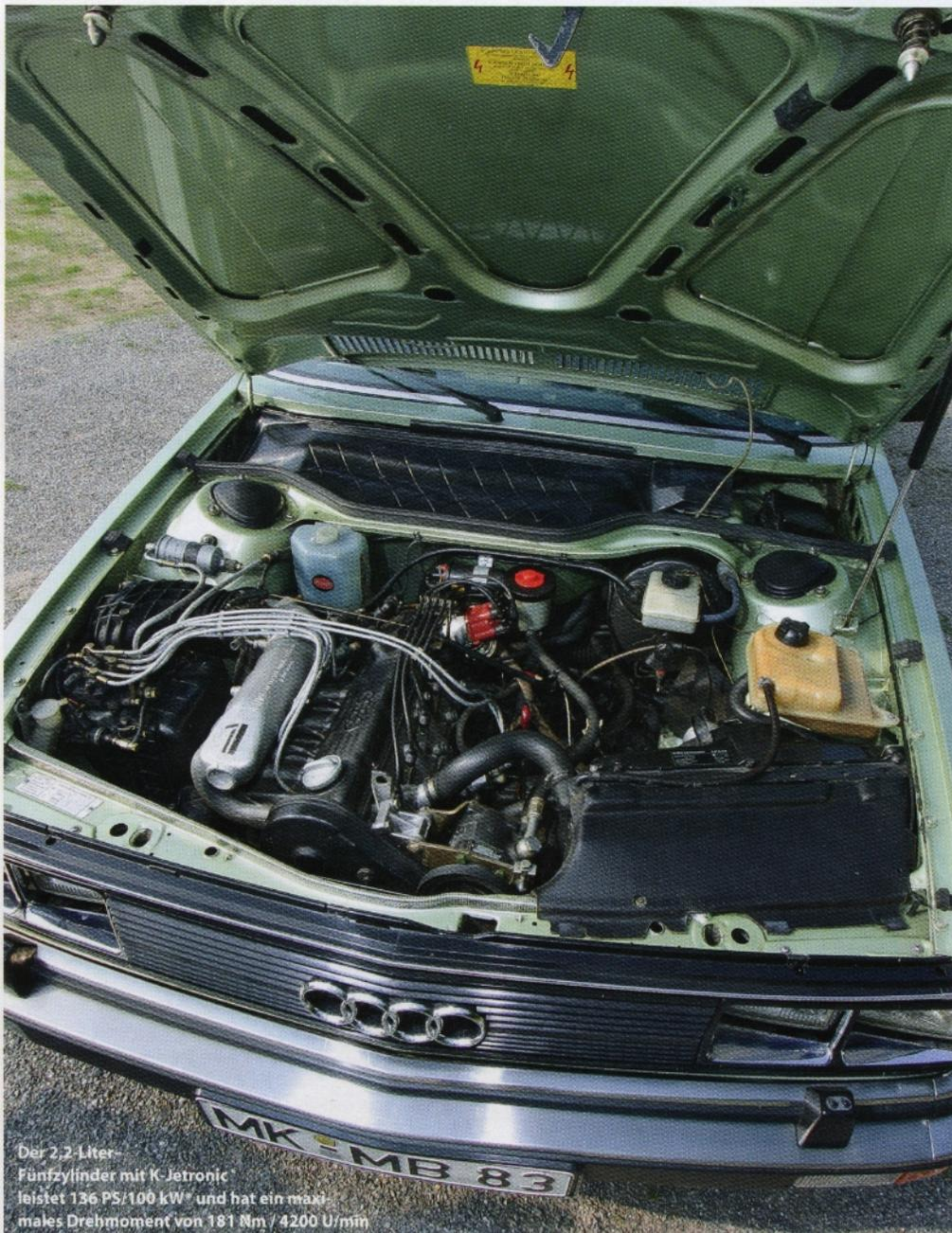
Der 2,2-Liter-Fünfcylinder mit K-Jetronic leistet 136 PS/100 kW\* und hat ein maximales Drehmoment von 181 Nm / 4200 U/min
