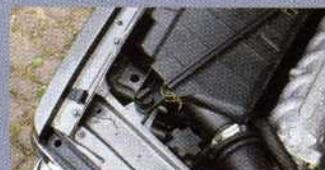
Die 88-Ah-Batterie des Fünfzylinder-Turbodiesel liegt unzugänglich und versteckt unter dem Luftfilterkasten
