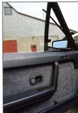
Trotz Klimaanlage: Die Ausstellfenster in Grünolor hat Jörg nachgerüstet
