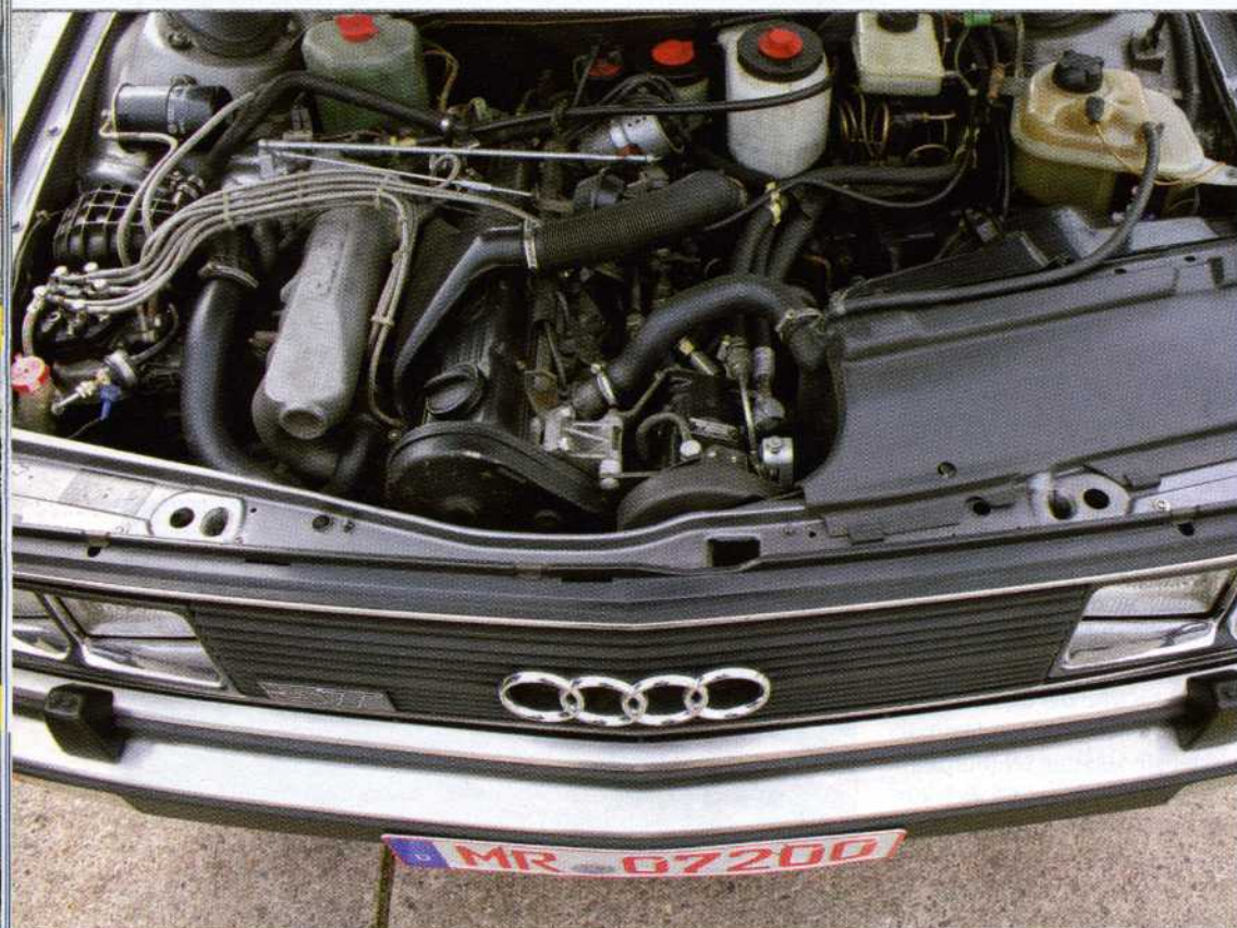
Der 2,2-Liter-Fünfcylinder mit Abgasturbolader und K-Jetronic leistet satte 170 PS/125 kW
