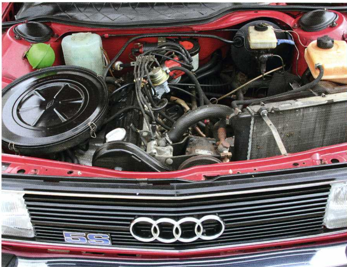
Der 2,1-Liter-Fünfzylinder leistet 115 PS/85 kW* bei 5400 U/min
