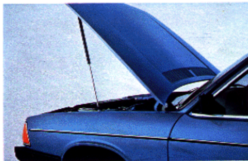
Motorhaubenfeststellung mit Gasdruckfeder. (GL)
