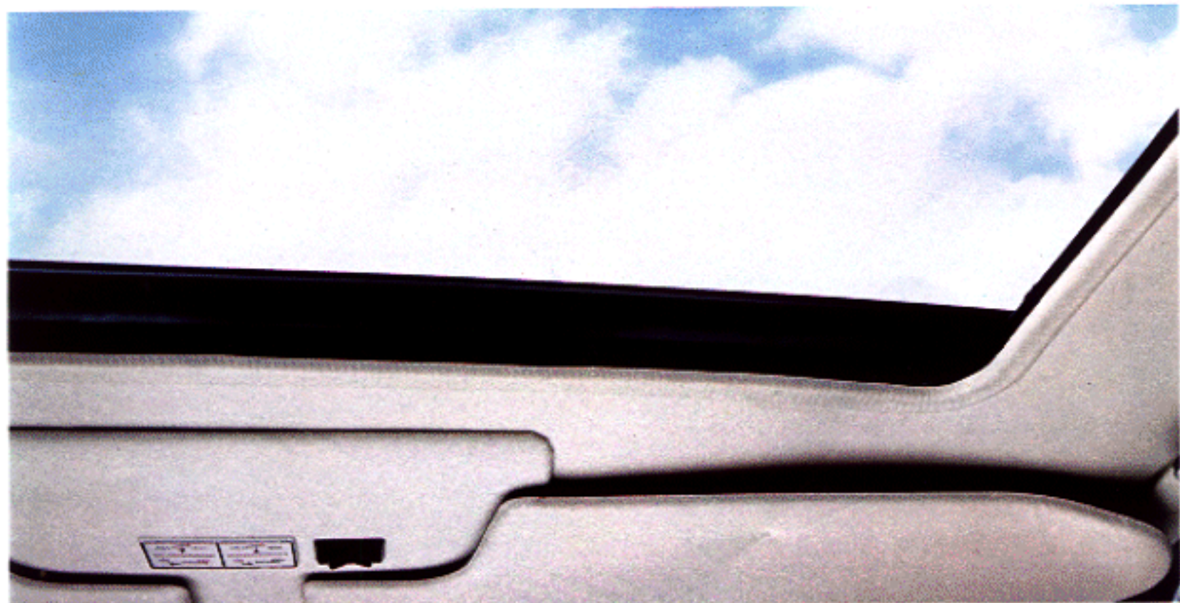
Das Schiebe-/Ausstelldach (hier elektrisch betrieben).
