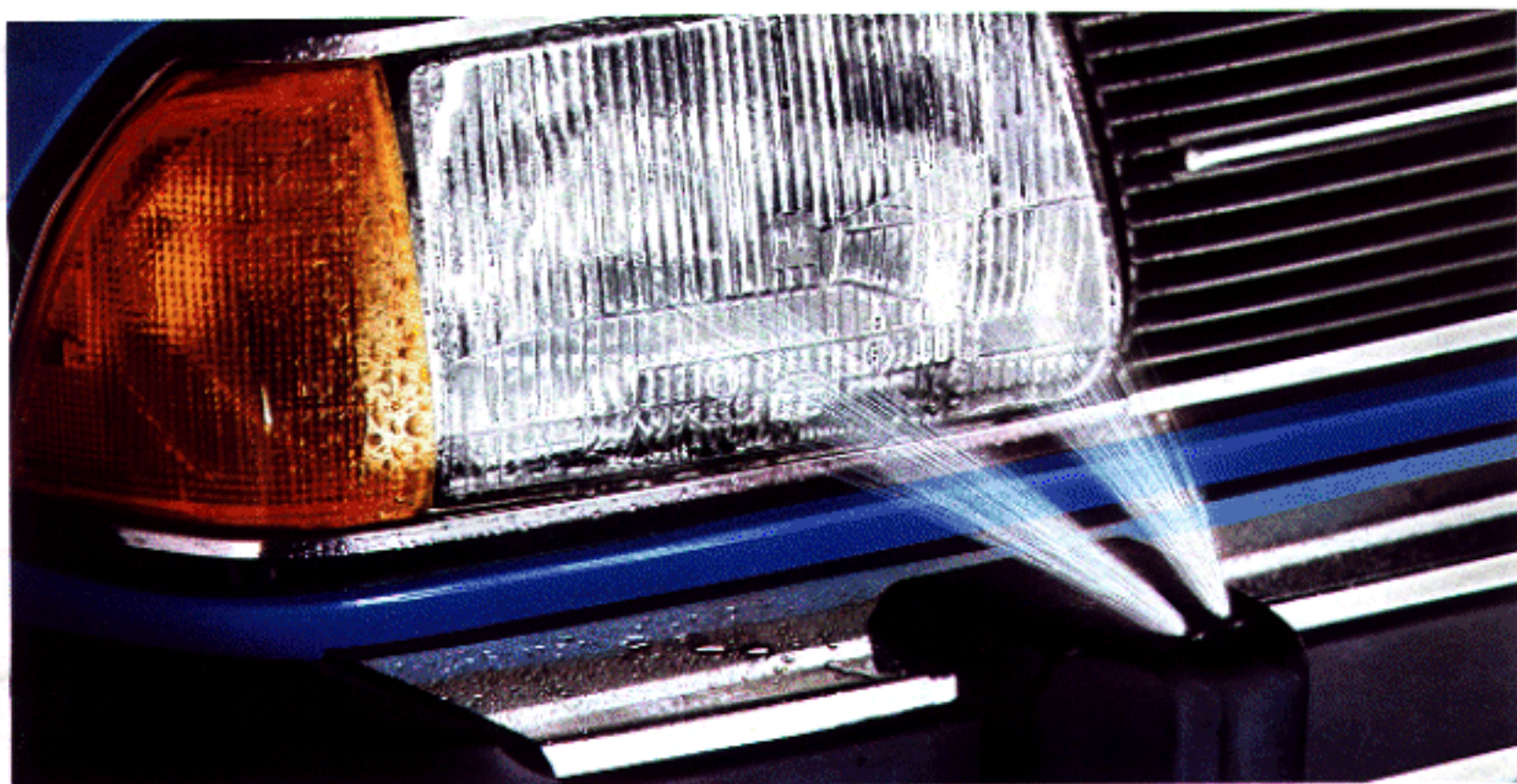
Die Scheinwerfer-Reinigungsanlage für sichere Sicht.
