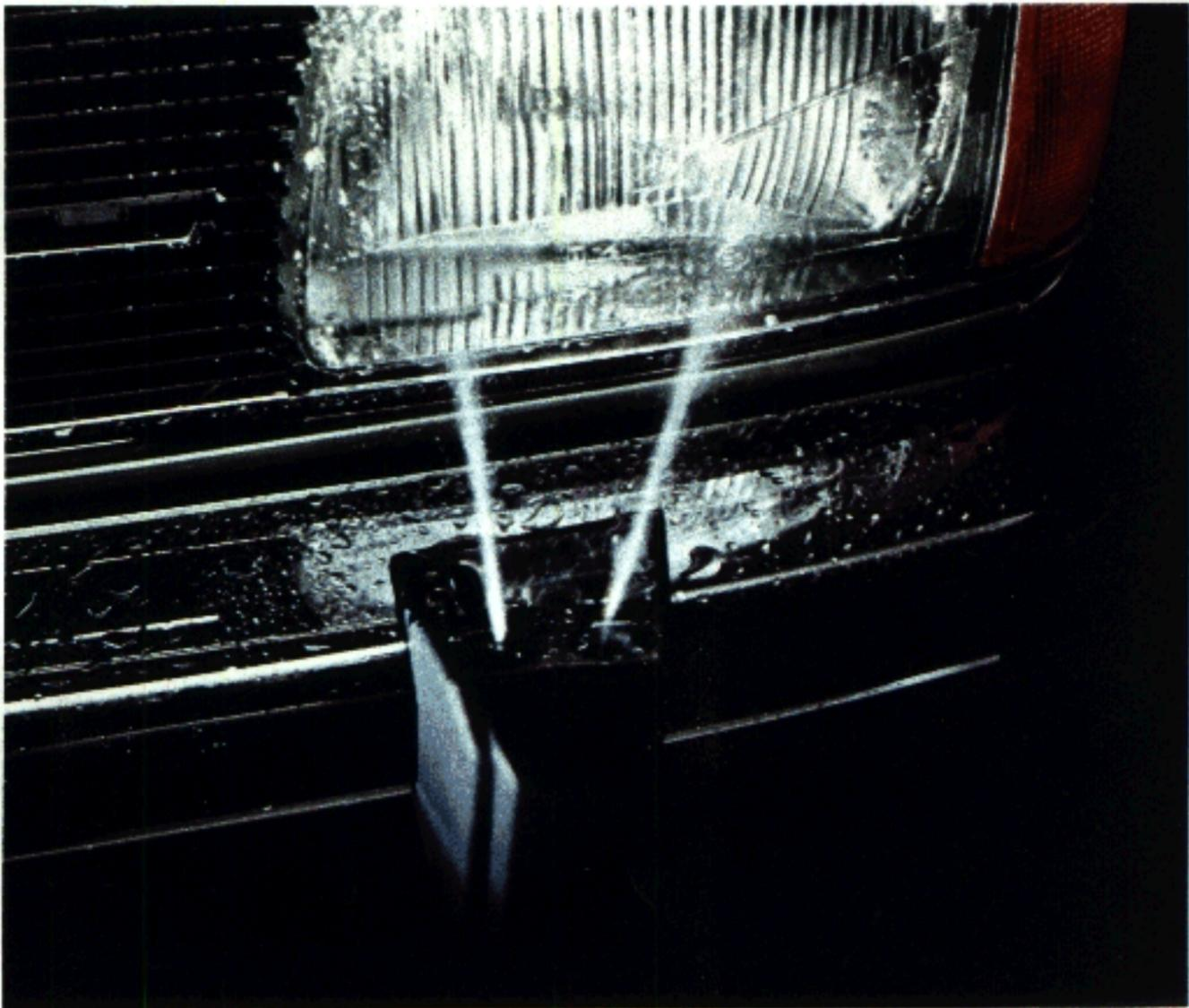
*Grâce à leur système de nettoyage, les phares restent propres et gardent leur pouvoir éclairant. Un léger encrassement peut en effet suffire à réduire considérablement l'intensité des rayons lumineux.*
