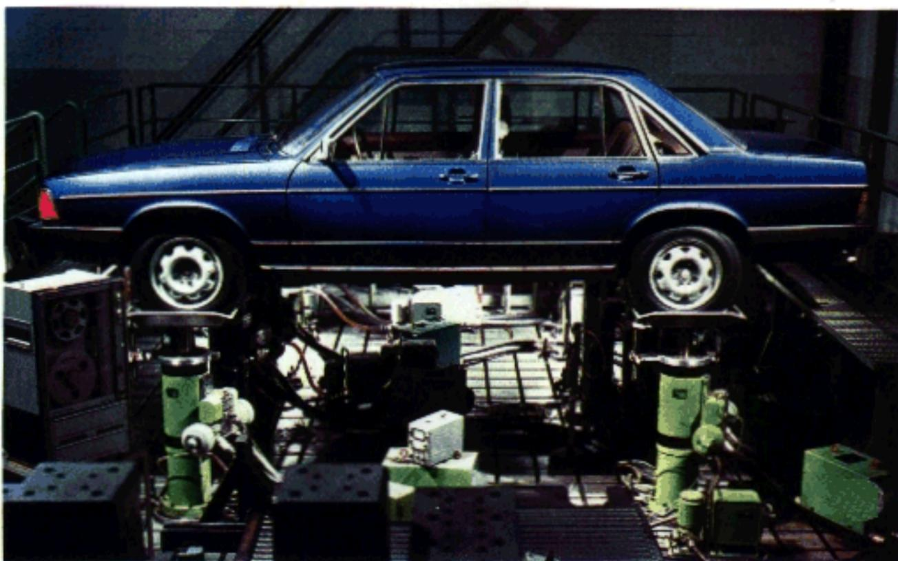
Les essais effectués sur le banc de simulation correspondent à un parcours de 850.000 km.
