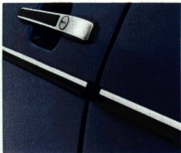
La voiture est ceinturée par des baguettes. Ces baguettes sont recouvertes de caoutchouc, pour diminuer les risques d'éraflure de la peinture au stationnement.
