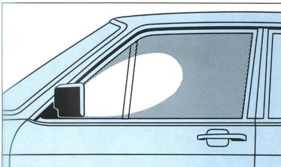
*Die Windströmung wird so geleitet, daß bei Regen oder Schnee die Sicht auf den Spiegel frei bleibt.*
