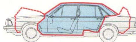
*Die Sicherheits-Passagierzelle wird vorn und hinten von computerberechneten Knautschzonen geschützt.*
