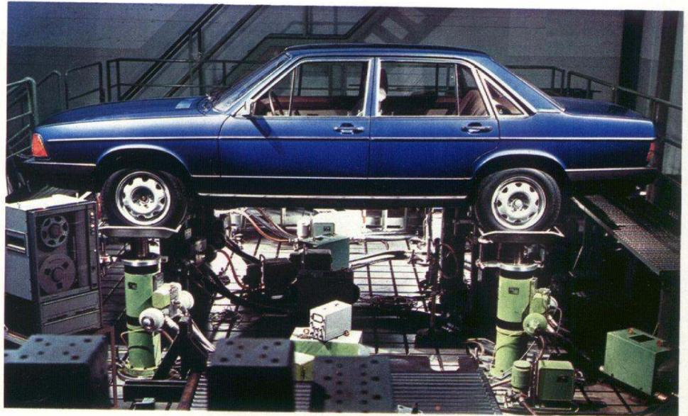
Die Tests auf dem Rüttelstand entsprachen einer Fahrstrecke von insgesamt 850.000 Kilometern.
