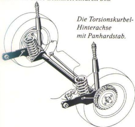
Die Torsionskurbel-Hinterachse mit Panhardstab.
