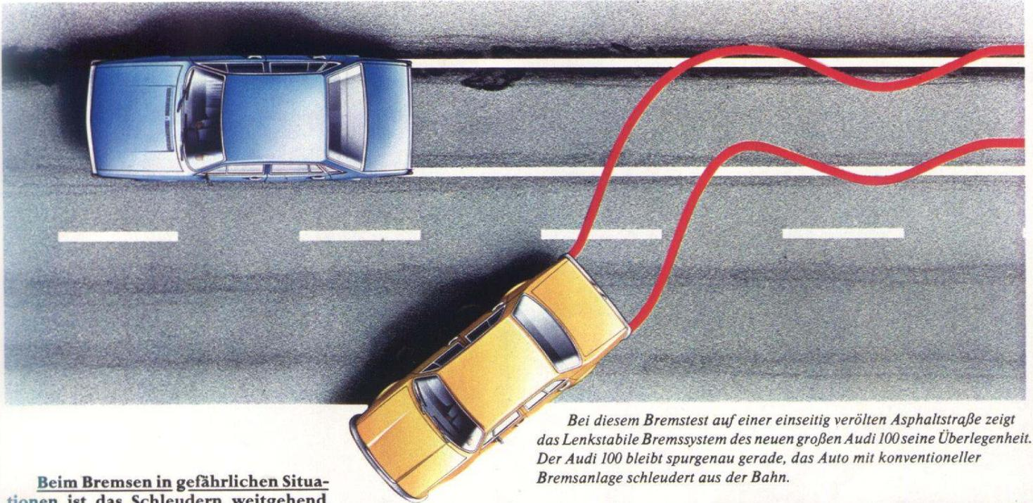
Bei diesem Bremstest auf einer einseitig verölten Asphaltstraße zeigt das Lenkstable Bremssystem des neuen großen Audi 100 seine Überlegenheit. Der Audi 100 bleibt spurgenaue gerade, das Auto mit konventioneller Bremsanlage schleudert aus der Bahn.
