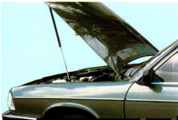
Motorhaubenfeststellung mit Gasdruckfeder (GL).
