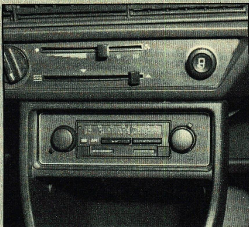
Das im Dauertest-Audi eingebaute Radio vom Typ Blaupunkt Neckarsulm zeichnet sich durch drei Empfangsbereiche (UKW, MW, LW) aus und besitzt ein Cassettenfach für Stereowiedergabe.
