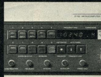
... plus Sender-Suchlauf-Automatik. Wenn Sie aber «alles aus dem Äther holen möchten», eröffnet Ihnen der B780 eine ungewohnte Bedienungsvielfalt. Beispiel: Automatischer Sendersuchlauf. Er bestreicht den ganzen UKW-Empfangsbereich und stoppt bei allen Sendern, welche die von Ihnen vorgewählte Empfangsqualität aufweisen — etwa nur stark einfallende oder nur Stereo-Sender. Vorbereitet für Anschluss einer Rotor-Antenne sowie für den Empfang rauschunterdrückter UKW-Sendungen.
